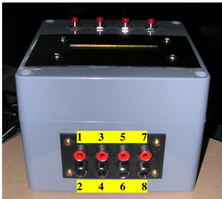
**Figure 3 : Connecteurs femelles du boîtier et numéros de voies**
